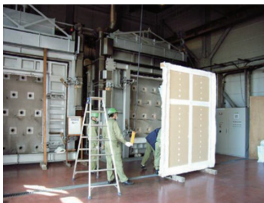
(b) 耐火炉と壁試験体
