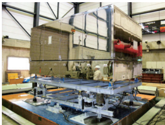
図8 3次元床免震システム：震動台実験中
