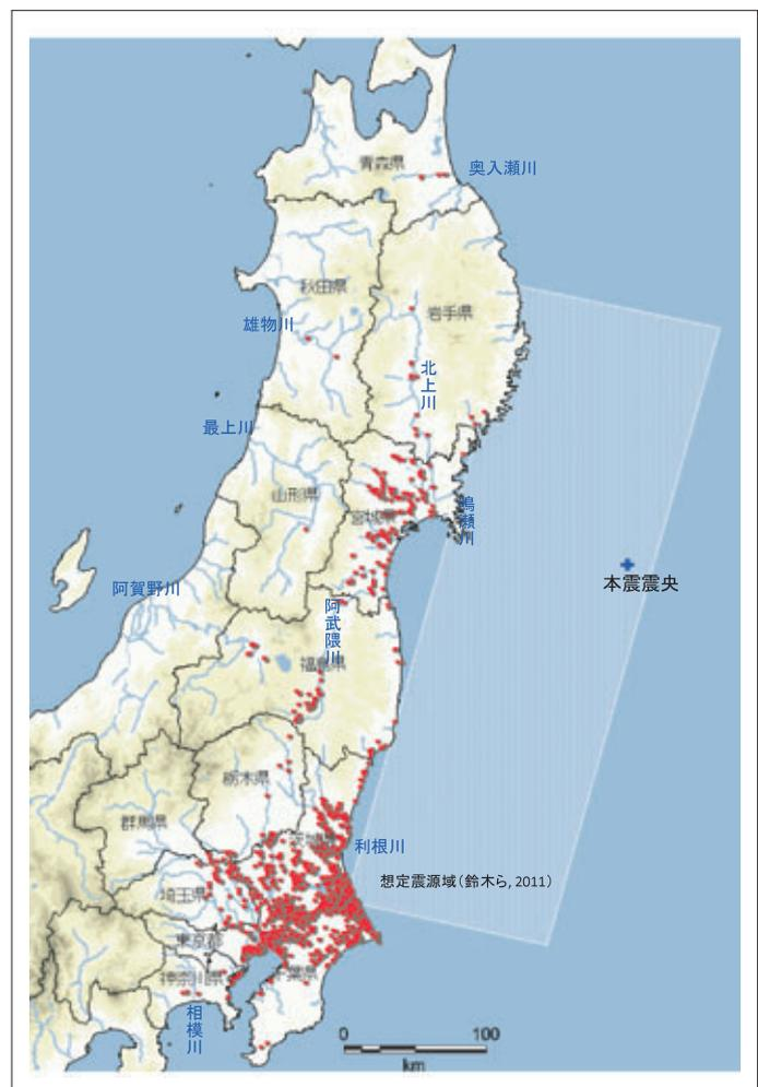
図3 液状化による湧水で冠水した土地
