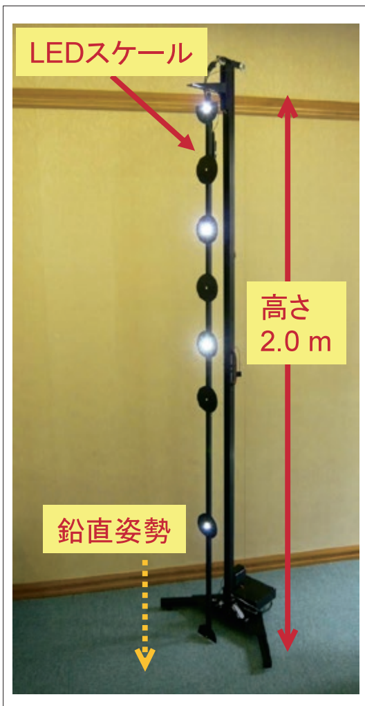
図3 身長計測を目的とした防犯カメラキャリブレーション装置
