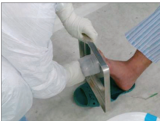
図2 遮蔽体を使用した汚染検査
