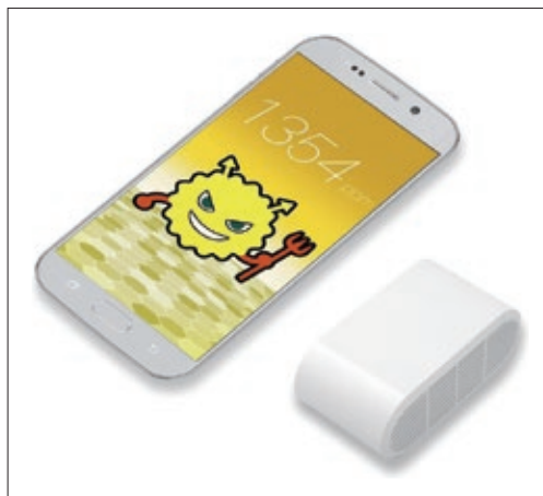
図2 ポケットCO 2 センサー
