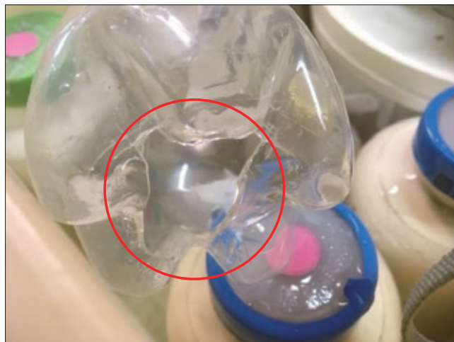
図2 ペットボトルの底部の破損箇所
