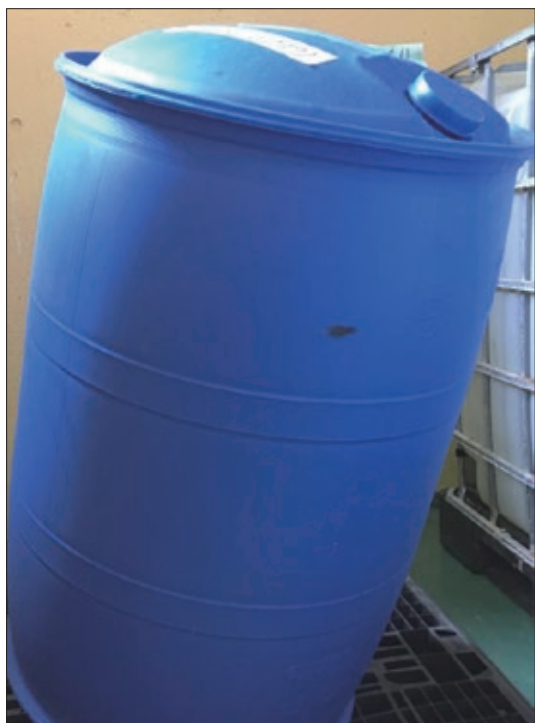
図3 ガス発生で変形した樹脂製のドラム
