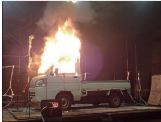
図7 軽トラック燃焼実験
