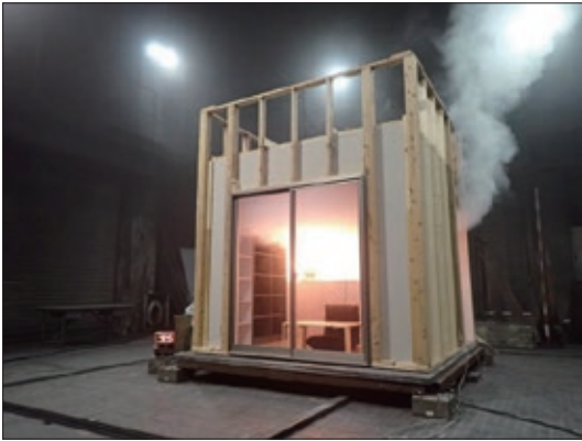
図6 天ぷら火災による建物燃焼実験
