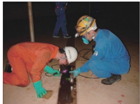
図8 磁力を用いた非破壊検査による審査状況
