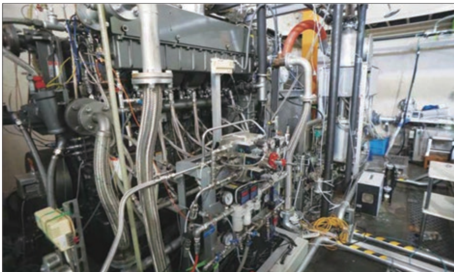
形式：希薄燃焼/副室火花点火/6気筒 シリンダ径/行程：155 mm/180 mm 発電出力/回転速度：400 kWe/1800 rpm
