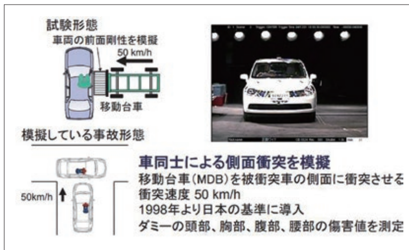
図7 側面衝突試験法
