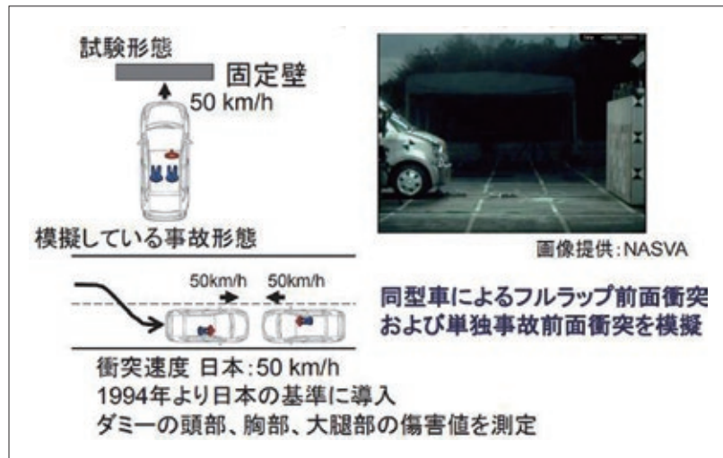
図4 前面衝突（フルラップ）試験法
