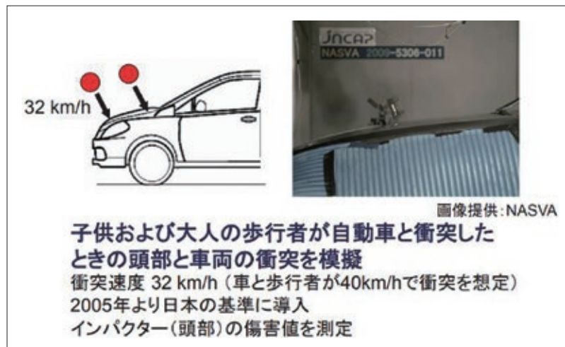
図9 歩行者保護試験法（頭部保護フード試験）
