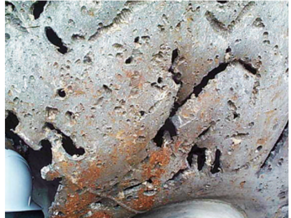
図4 凝縮相の爆ごう 爆心近傍の金属容器に開いた貫通孔
