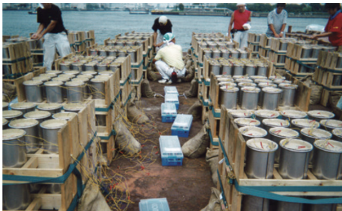
図3 打揚台船上における電気点火の結線作業
